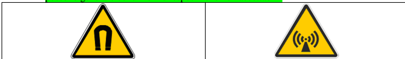
Figura 4.2: segnaletica di presenza di campi magnetici e di radiazioni elettromagnetiche che possono generare condizioni di esposizione non accettabili.
